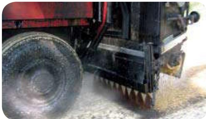
*Foto sopra: particolare della stesura dello strato superficiale*
